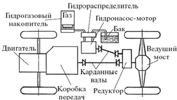
Рис. 2. Схема автомобиля с системой рекуперации энергии торможения
