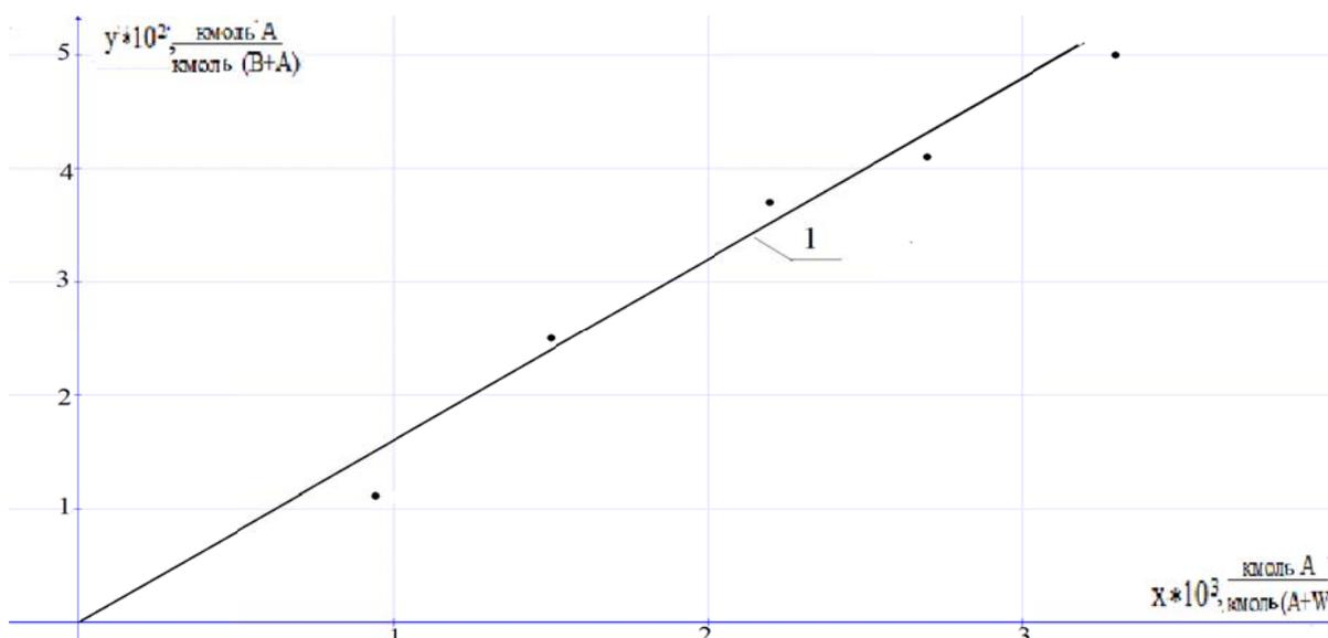
Рис. 3. Зависимость равновесной концентрации  $\text{CO}_2$  в воздухе от концентрации  $\text{CO}_2$  в водном растворе моноэтаноламина (1) (• – экспериментальные точки для пяти опытов)
