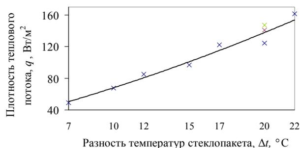
Рис. 3. Экспериментальные распределения плотности теплового потока  $q$  от разности температур  $\Delta t$  однокамерного стеклопакета (4–16–4)
